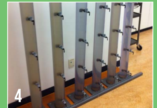
4 Décantation variée en fonction des proportions de mélanges des deux types d'effluents
