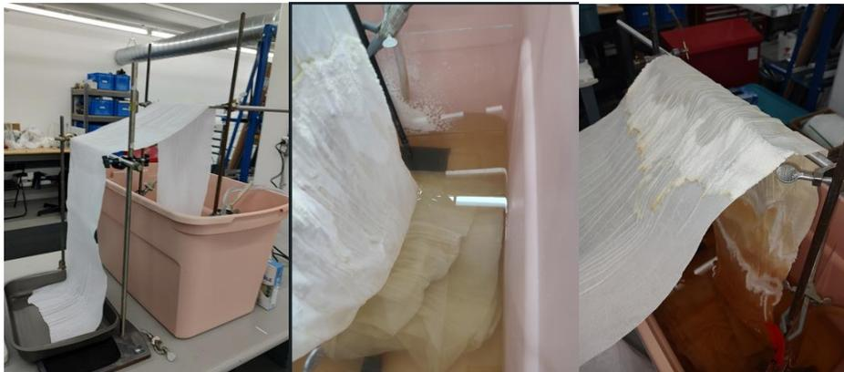
*Figure 17: Configuration de dessalement passif à voile - Essais de cristallisation sur le voile en coton du pilote.*
