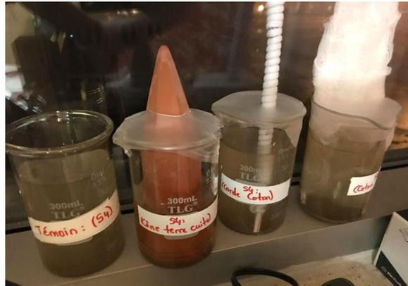
*Figure 8: Support utilisés lors des essais d'évaporation par capillarité*
