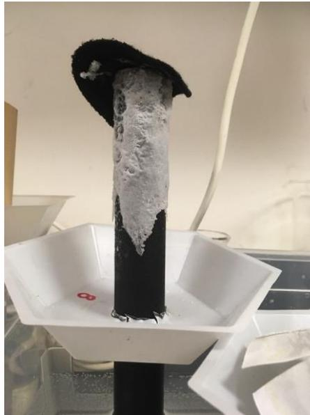
Figure 13: Prototype de dessalement passif Hamzalex - Représentation du tube poreux en charbon avec le filtre de bambou noir
