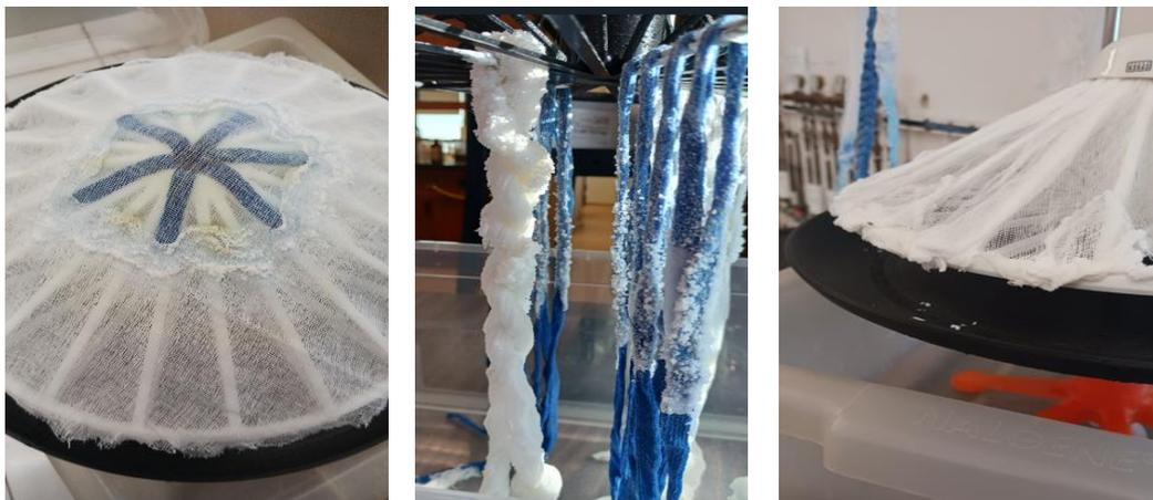
Figure 19: Amélioration de la configuration de dessalement passif « champignon » - Sommet du champignon avec les fils bleus apparaissant en transparence (Gauche), cordes bleues et corde torsadée (centre) et Configuration champignon avec toile de coton unique pour chapeau et corde(droite).
