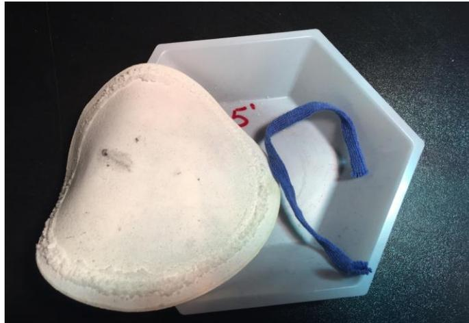
*Figure 11: Prototype de dessalement passif « champignon » - Accumulation de sels en bordure des filtres.*
